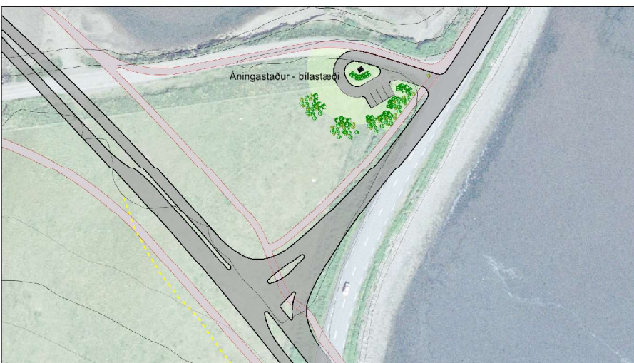
SKÝRINGARMYND: Áningarstaður við stöð 700 sunnan við brúna yfir Eskifjarðará, mkv. 1:1000. Gert ráð fyrir bílastæðum fyrir allt að 5 bíla, má koma fyrir borðum, bekkjum og upplýsingaskiltum.
