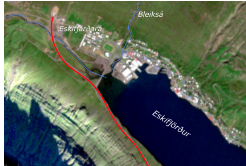
Mynd 4 Þéttbýlið Eskifjörður við botn Eskifjarðar. Á myndinni sést nýr vegur með ströndinni frá Norðfjarðargöngum (rauð lína), Eskifjarðará renna undir tvær brýr og hvernig Bleiksá rennur með núverandi landfyllingu til sjávar.
