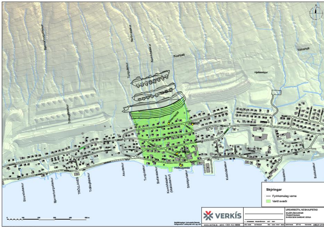
Mynd 3 Hús sem varin yrðu með fyrirhuguðum varnavirkjum undir Urðarbotni og Sniðgili (2 bls. 18 teikningar, U60.01.018).
