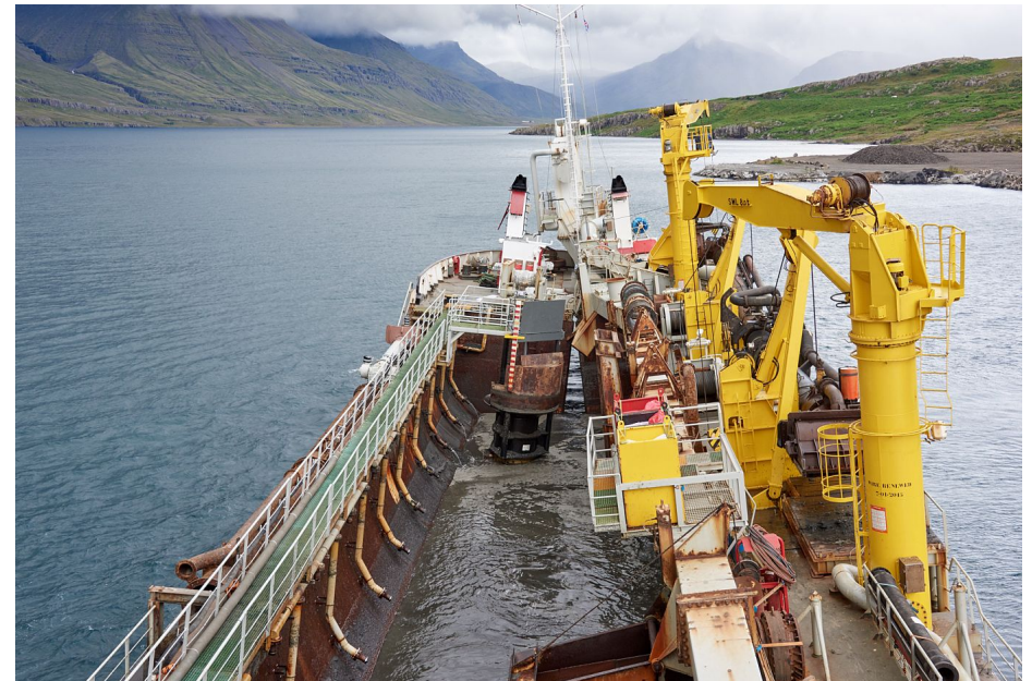
Mynd 2.5 Botnlúgan opnuð á Galilei 2000 yfir öðrum stækkunaráfanga Mjóeyrarhafnar og efni sleppt. Parna sést hvernig skutur skipisins er opnaður.
